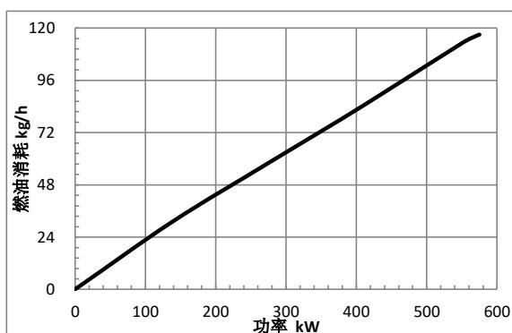
以上所有的数据都是基于或修正至SAE J1349标准规定的条件——海拔90m (300ft.)，大气压力100kPa (29.61in.Hg)，进气温度25°C (77°F)，水蒸汽压力1.0kPa (相对湿度30%)，使用符合GB 252标准的0号柴油或符合ASTM D2标准的柴油。
